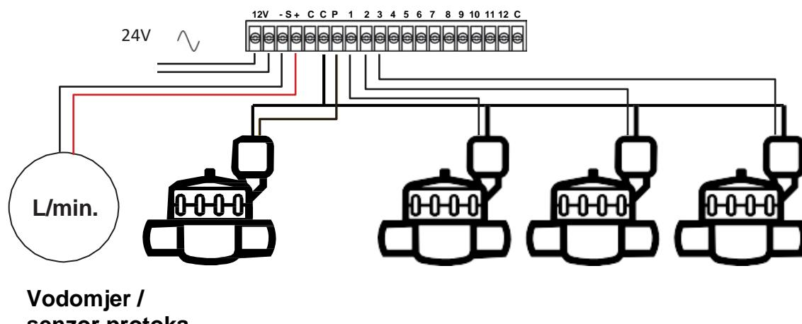
Priključite na terminal - **S +** kabele vodomjera s impulsnim izlazom, kako je iznad opisano. Koristite vodomjer s čitačem impulsa s beznaponskim kontaktima. Za preciznije očitanje preporučamo koristiti vodomjere s čitačem impulsa rezolucije 10 l/impuls ili 1 l/impuls.
